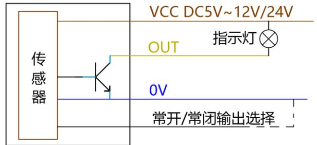
NPN 输出驱动小型继电器(线圈电流 $\leq 100\text{mA}$ )工作原理：
