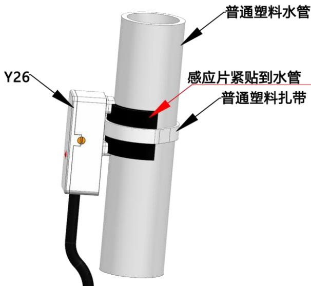
被感应液位高度与传感器灵敏度有关, 灵敏度越高, 被感应的液位相对较低
