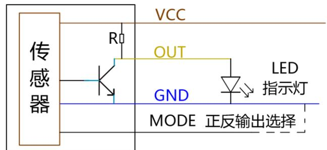
高低电平输出驱动小型继电器(线圈电流 $\leq 100\text{mA}$ )工作原理:
